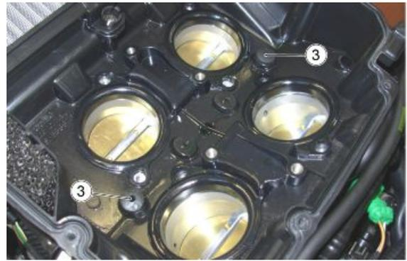
Pour que le moteur fonctionne correctement, une des deux vis de chacun des boîtiers papillons doit être **toujours** bloquée.
