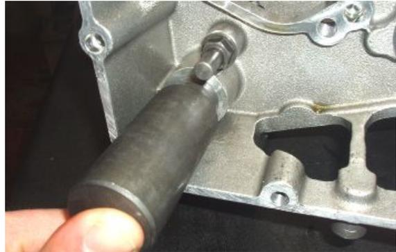
**Equipement spécifique****020862Y Pointeau de montage de la cage à rouleaux de la tige de commande de la boîte de vitesses**
