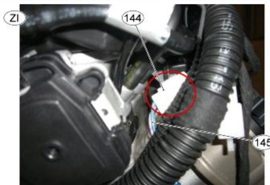
144. Connecteur du câblage du capteur du sélecteur de vitesses
