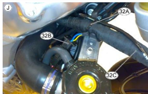
**PLANCHE J1 - ACTIONNEUR DE LA SOUPE D'ÉCHAPPEMENT**
