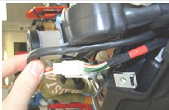
Le connecteur mâle avec le câble ayant la bande rouge doit être accouplé au connecteur femelle avec le câble le plus long.
