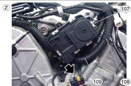
106. Passage du câblage (faisceau « 4 ») sous le tuyau d'essence
