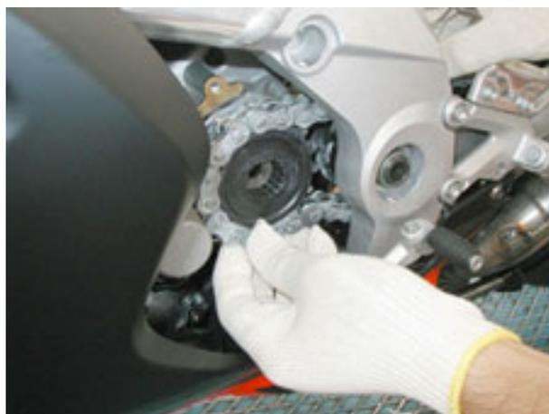
**IMPORTANT** Enduire le filetage de la vis de LOCTITE® 243.
