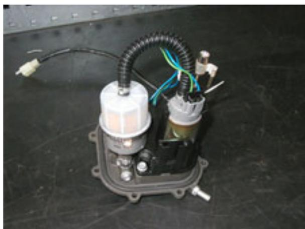
**3.2.2. DÉPOSE DU CAPTEUR DE NIVEAU CARBURANT**
