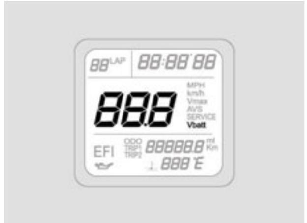
Réglage de l'éclairage de l'instrument : il est possible de régler l'intensité du rétro-éclairage de l'instrument sur 3 niveaux (30%, 70%, 100%) ; la variation n'est possible que pendant les 5 premières secondes après avoir tourné la clé en "ON" par la pression de la touche " - ".
