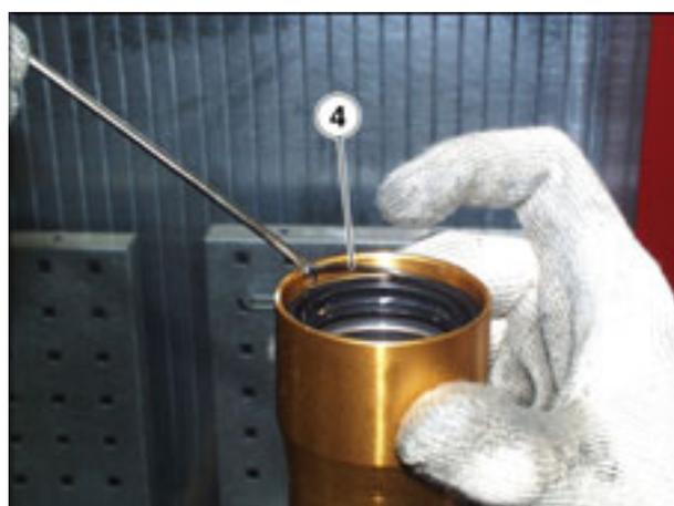
**IMPORTANT** Placer une bande caoutchouc sur le bord du fourreau pour ne pas l'abîmer en retirant le joint SPI (5).
